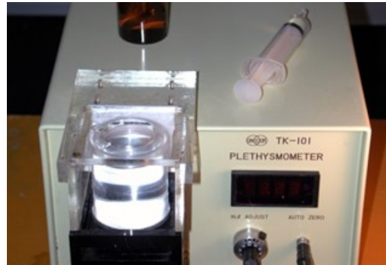
マウス・ラット後肢足蹠浮腫容積測定装置 (TK-101CMP、有限会社ユニコム)
