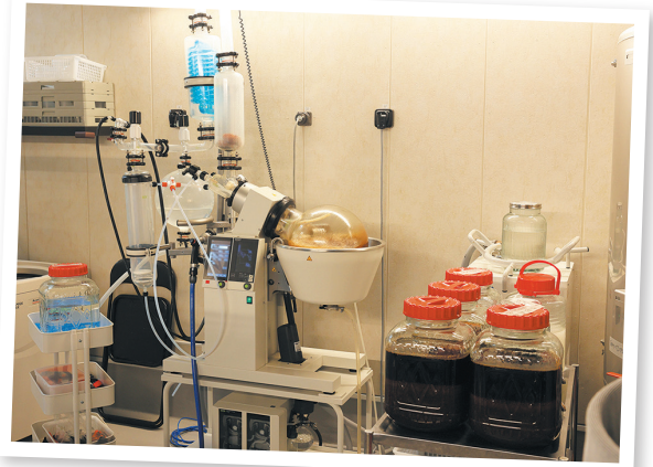
ロータリーエバポレーター
